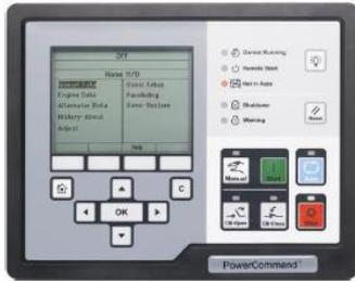
Un sistema de control del grupo electrógeno integrado basado en microprocesador que proporciona regulación de voltaje, protección del motor, protección del alternador, interfaz del operador y control isócrono. Para obtener información más detallada consulte el documento S-1567 e S-1570.
